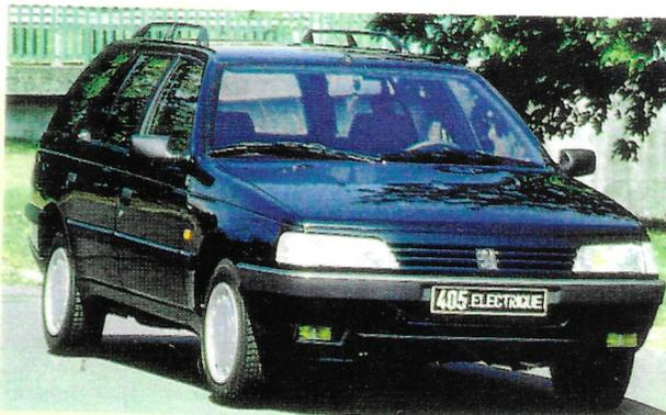
ville, son moteur électrique est alimenté par des batteries ; pour les longs déplacements, par un groupe électrogène. Il s'agit d'un moteur à explosion fonctionnant au gazole et entraînant une bobine à 3 500 tours par minute dans un champ magnétique. Le courant produit permet de recharger les batteries et d'alimenter le moteur électrique de la voiture. La vitesse de ce véhicule peut monter à 130 km/h. Un plein de
